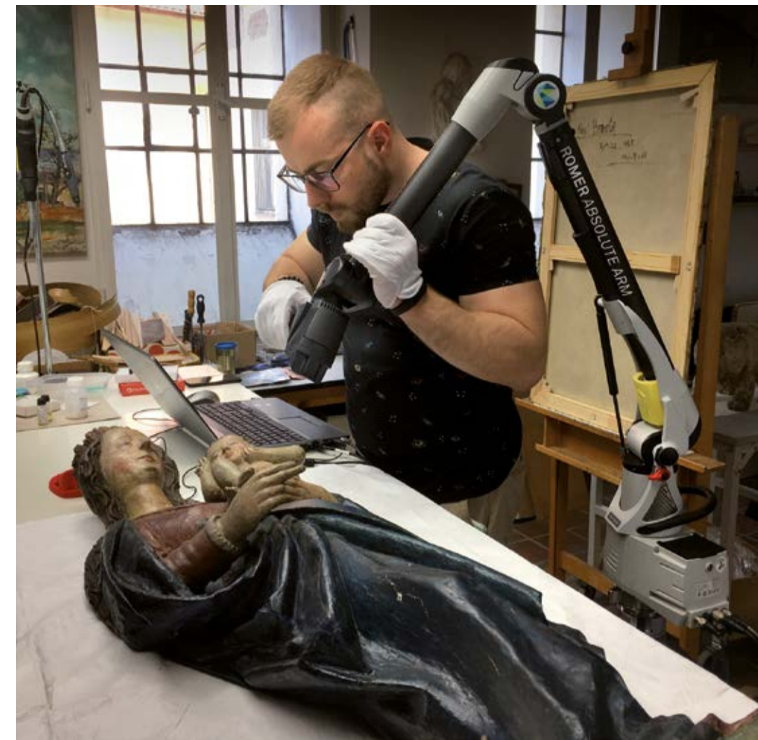
Jeden z fyziků pracuje s ramenem mobilního 3D skeneru a snímá bezkontaktně povrch sochy.
